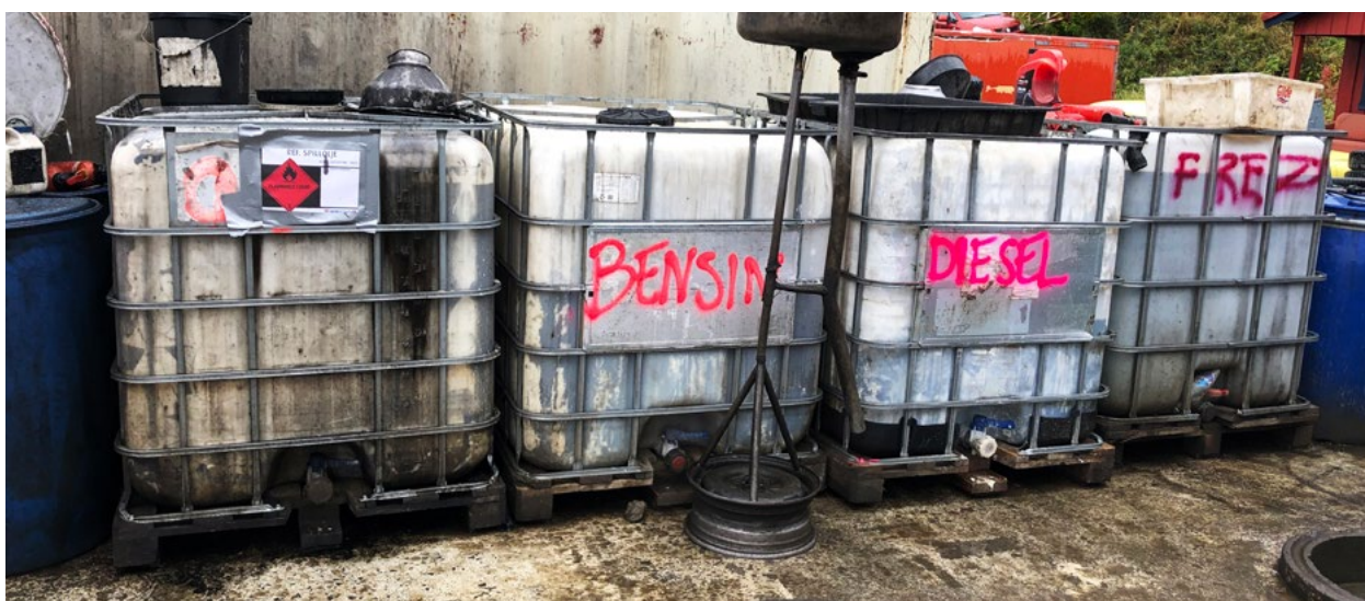
FARLIG STOFF: Feil oppbevaring av brennbare væsker kan utgjøre en risiko for både miljø og brannsikkerhet.
